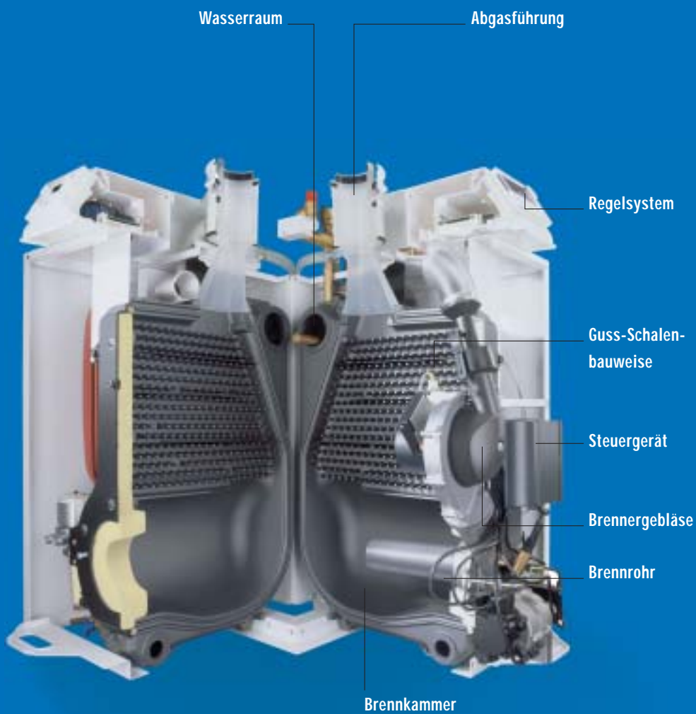
Aufbau eines modernen Öl-Gussheizkessels mit Blaubrenner (Schnittdarstellung des Öl-Kompaktheizkessels Logano plus GB135)
